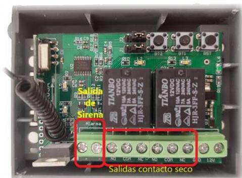
La configuración del dispositivo ofrece dos opciones de uso para las salidas de los relevadores, teniendo el modo pulsante y enclavado;
